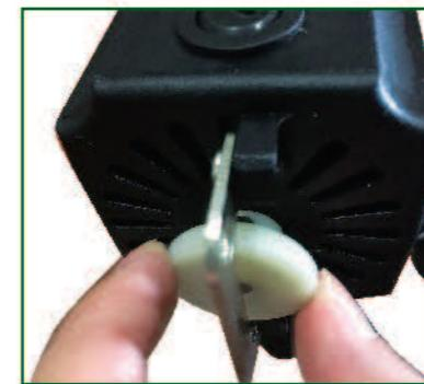
转动手轮时，相当于手动运转机器，便于调试机器和更换零件。
