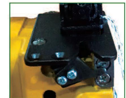
工作时，降线瓣引入割线槽中，线自动割断。
