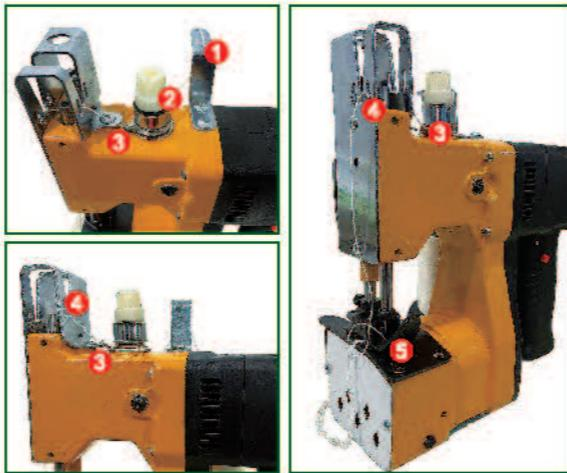
注：穿好线后在袋子上缝一次才后打结，空缝不打结。
